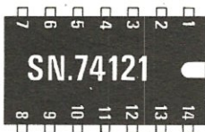
Fig. 2 Disegno dell'integrato SN74121 così come appare visto dal di sopra. La tacca che trovasi sul suo involucro serve come riferimento.
